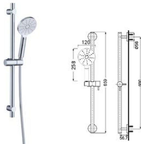
B-13 升降杆 Sliding bar 材料 /Material: 不锈钢 /SUS304
